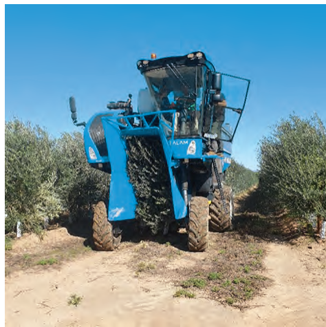
Máquina cabalgante durante la recolección de una plantación de manzanilla cacereña en seto
